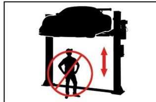
Der Aufenthalt von Personen (beim Heben oder Senken) unter der Hebebühne ist verboten!
