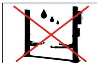
Hebebühne vor Feuchtigkeit schützen! Elektrische Anschlüsse müssen zwingend trocken sein!
