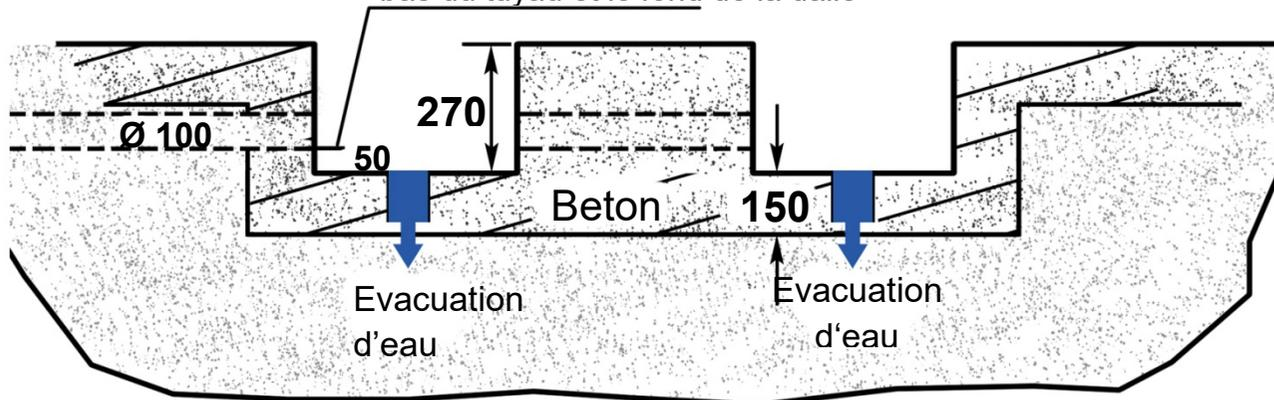
Béton C20 / 25 selon DIN 1045-2 (ou DIN EN 206-1), désignation selon l'ancien béton DIN 1045 B25. Se compose de CEM II 32.5 selon EN-197-1, groupe de grains 0/22, granulométrie 22 selon DIN EN 12620. Plancher horizontal et planéité inférieure à 5 mm sur toute la surface. Le béton neuf doit reposer pendant 28 jours.
