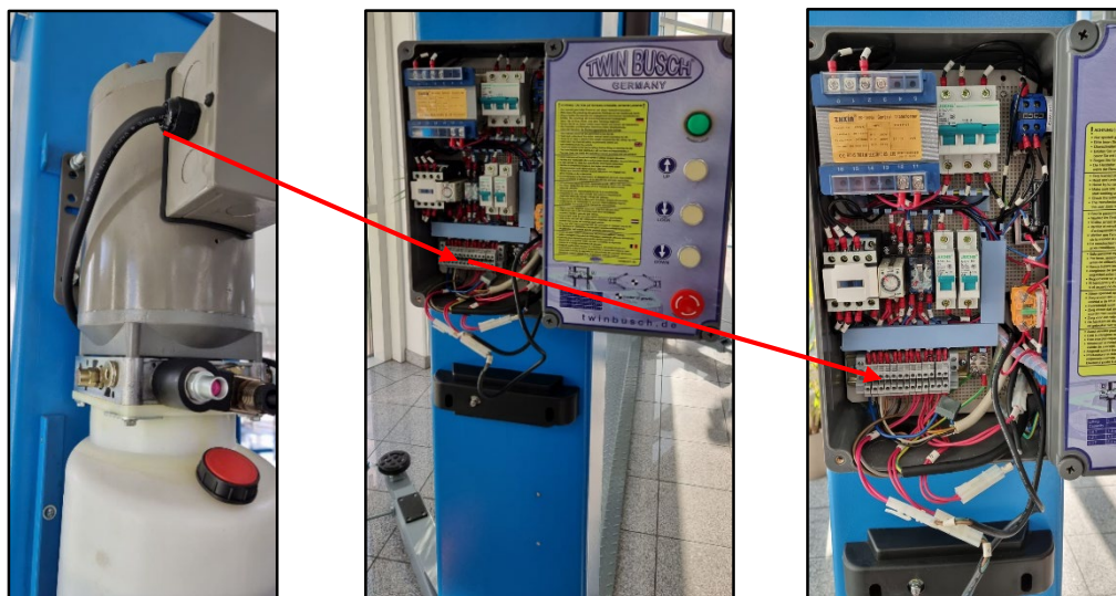
Afbeelding: De voeding aansluiten op de besturingseenheid
